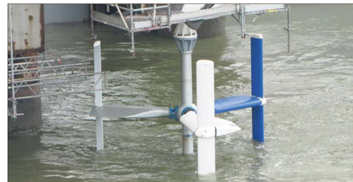
De 'slagroomklopper' van Waverotor draait op stroming en golven.
